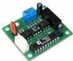
Модуль интерфейса RS485 для EI-7011 (PCB-RS485A-1)
