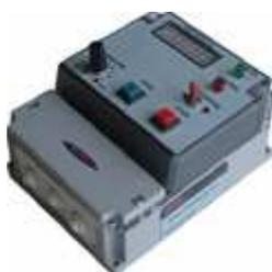
Пульт управления ПУ2Ц предназначен для дистанционного управления преобразователями частоты E2-8300, EI-P7002, EI-7011, EI-9011.
