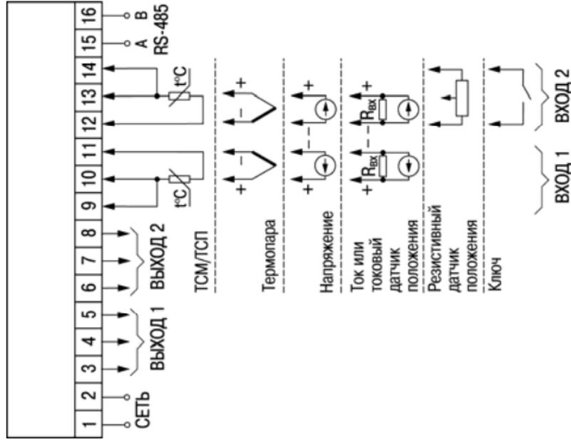
Рис. Б.1. Общая схема подключения ТРМ212
