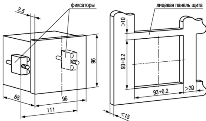
Рис. А.2. Прибор щитового крепления Щ1
