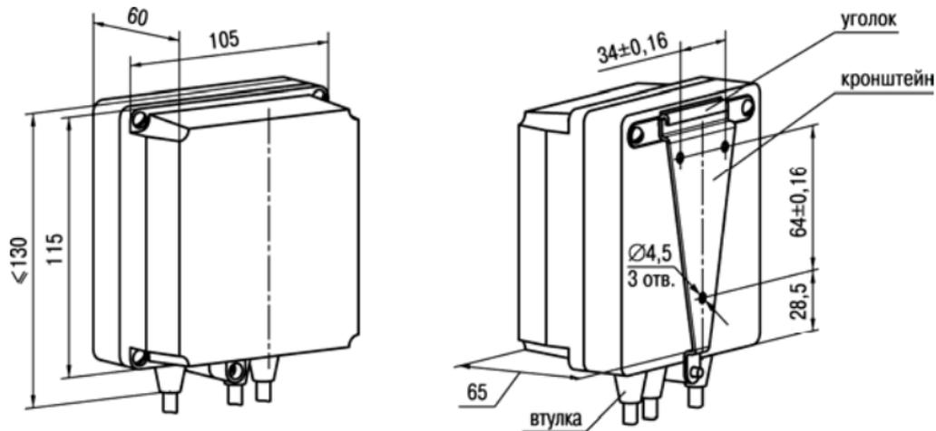
Рис. А. 1. Прибор настенного крепления Н
