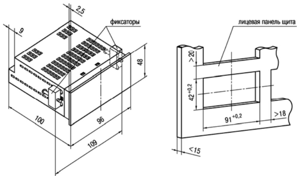
Рис. А.3. Прибор щитового крепления Щ2
