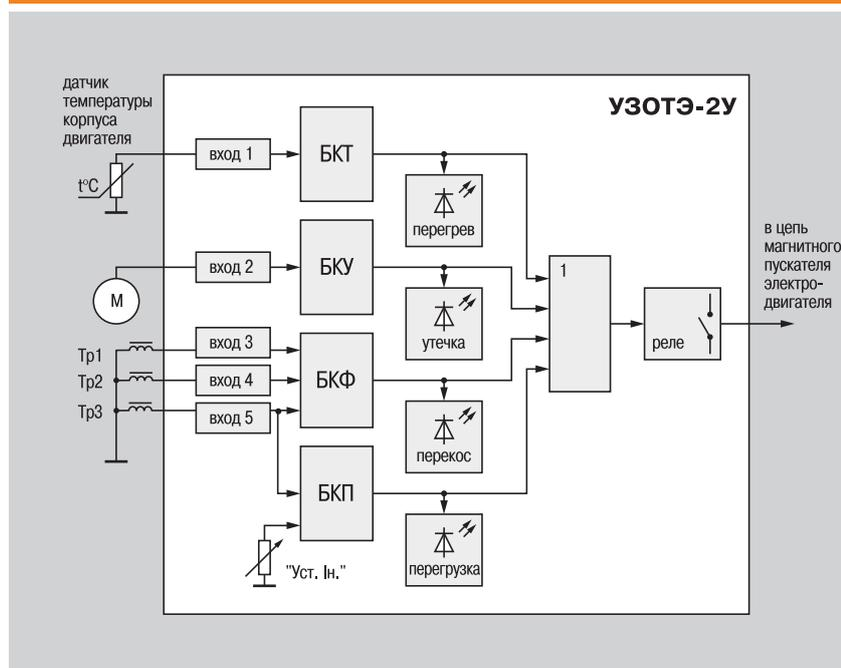
УЗОТЭ-2У включает в себя 4 блока контроля состояния электродвигателя:
