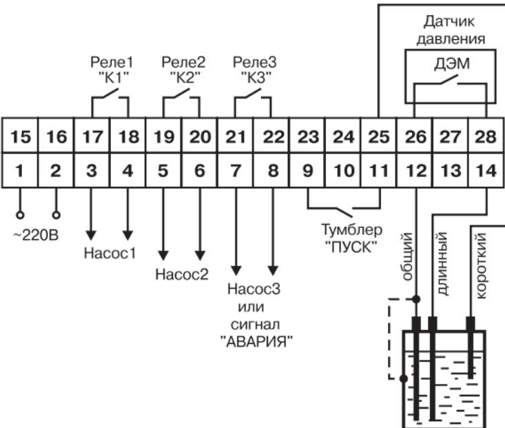
Рис. 40. Схема подключения САУ-МП
