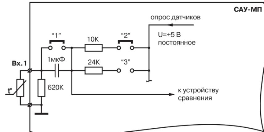
**Рис. 8. Подключение термисторов и позисторов**
