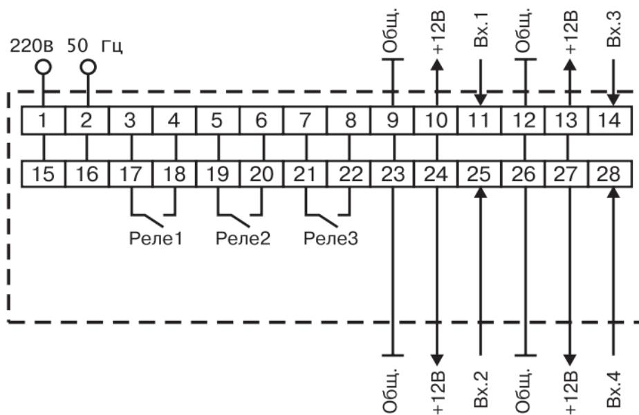
Рис. Б.2. Схема подключения прибора щитового крепления
