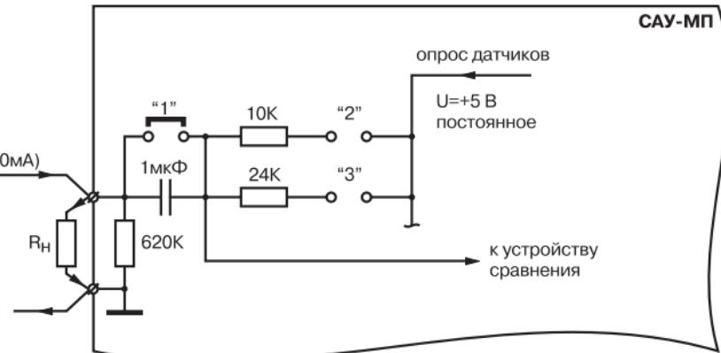
**Рис. 7. Подключение датчиков с унифицированным сигналом**
