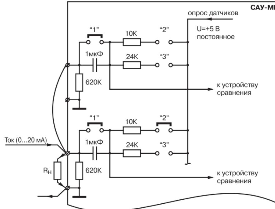
**Рис. 10. Параллельное подключение датчика с нормирующим преобразователем**
