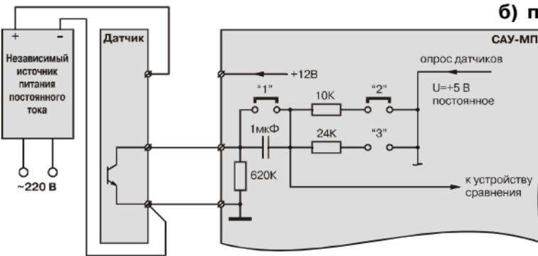
Рис. 5. Схема подключения емкостных выключателей
