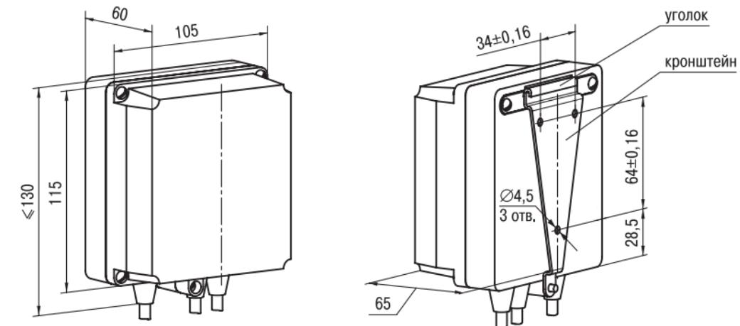
**Рис. А.1. Корпус настенного крепления типа Н**
