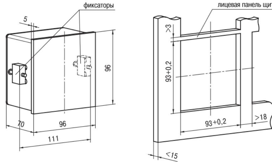
**Рис. А.2. Корпус щитового крепления типа Щ1**
