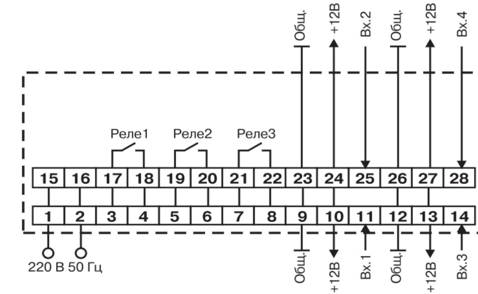
**Рис. Б.1. Схема подключения прибора настенного крепления**
