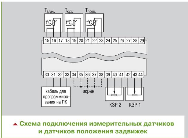
▲ Схема подключения измерительных датчиков и датчиков положения задвижек
