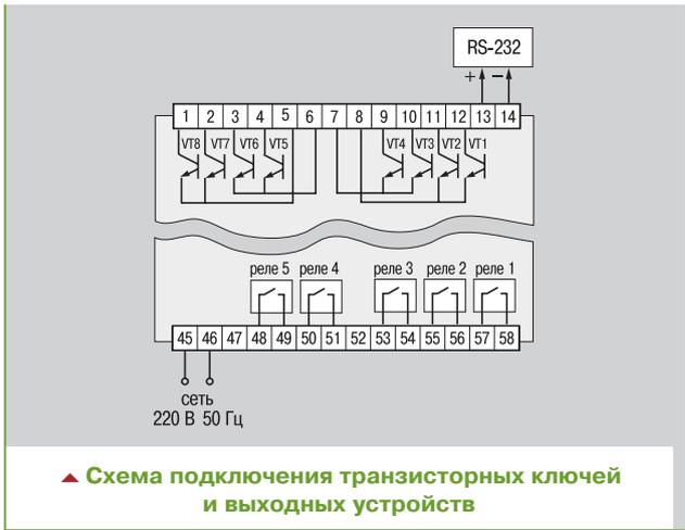
▲ Схема подключения транзисторных ключей и выходных устройств
