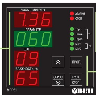
**Кнопка** в режимах ОСТАНОВ и РАБОТА предназначена для перехода между входными величинами, отображаемыми на индикаторе «ПАРАМЕТР». В режиме ПРОГРАММИРОВАНИЕ служит для перехода между параметрами при просмотре и для увеличения значения программируемого параметра при его изменении.
