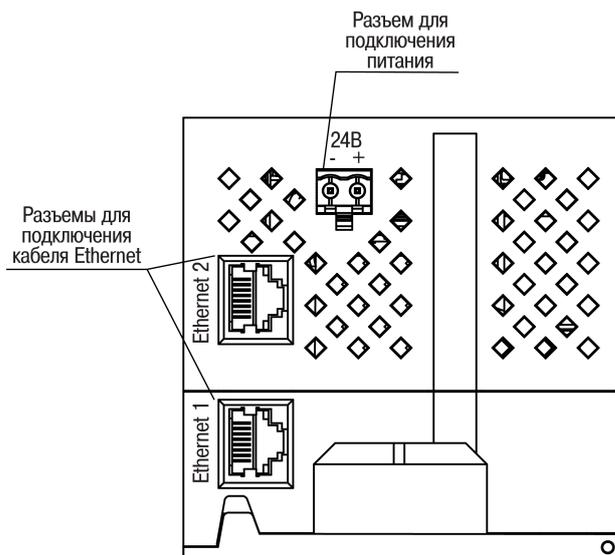
Рисунок 5.2 – Разъемы прибора
