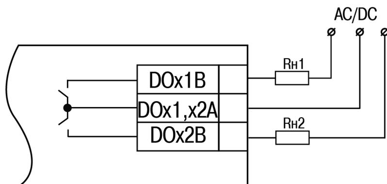
Рисунок 5.5 – Схема подключения к реле с общими контактами
