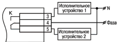
Рисунок 1.6 – Схема подключения нагрузки к ВУ типа Р
