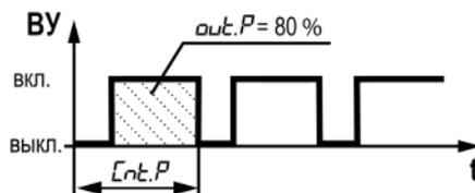
Рисунок 7.4 – Мощность дискретного ВУ
