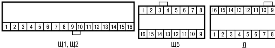
Рисунок 7.7 – Установка перемычки
