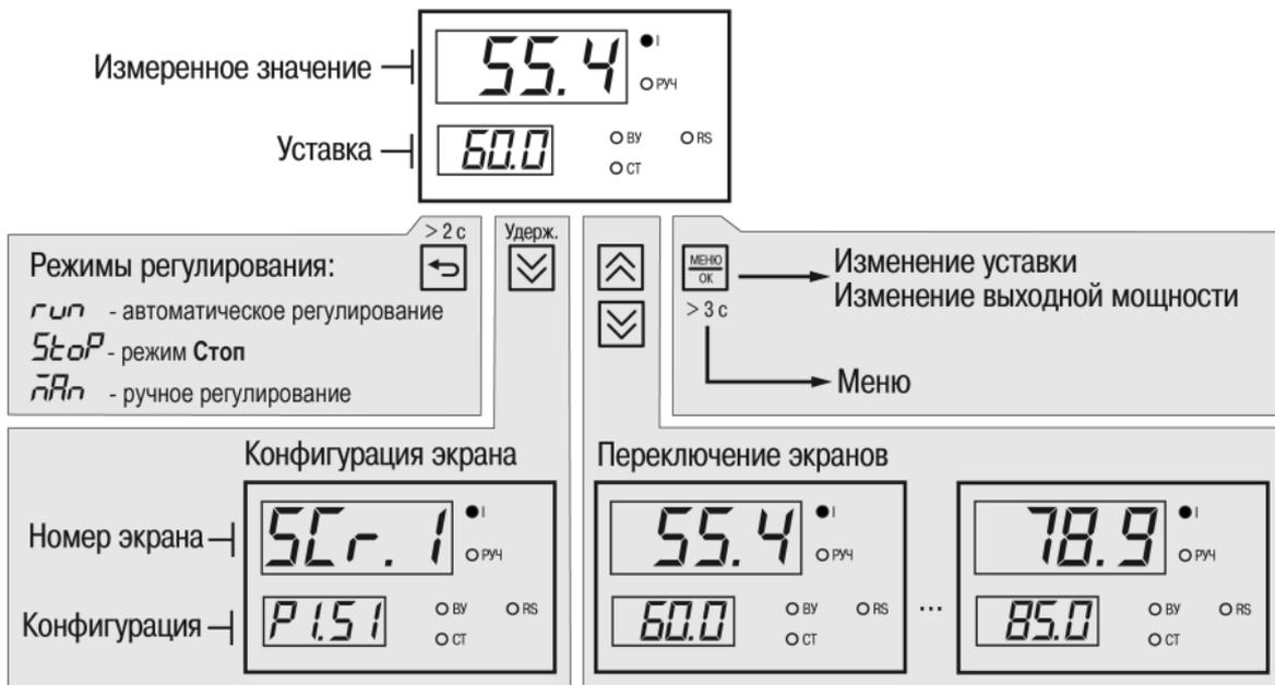
Рисунок 6.4 – Схема переходов с главного экрана
