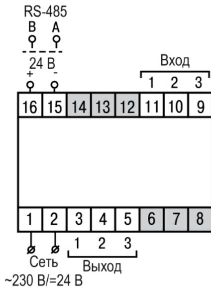
Рисунок 5.6 – Общая схема подключения ТРМ1-Д
