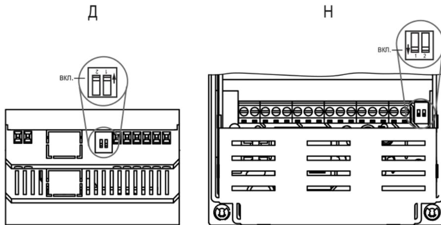
Рисунок 5.15 – Расположение DIP-переключателей для корпусов Д и Н
