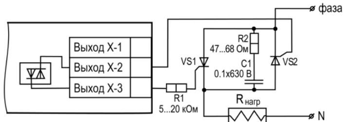
**Рисунок 5.20 – Схема встречно-параллельного подключения двух тиристоров к ВУ типа «С»**
