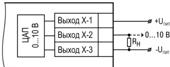
Рисунок 5.23 – Схема подключения нагрузки к ВУ типа «У»
