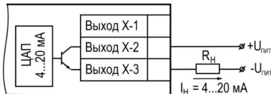
Рисунок 5.21 – Подключение к ВУ типа «И»
