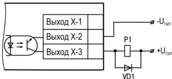
Рисунок 5.17 – Схема подключения нагрузки к ВУ типа «К»
