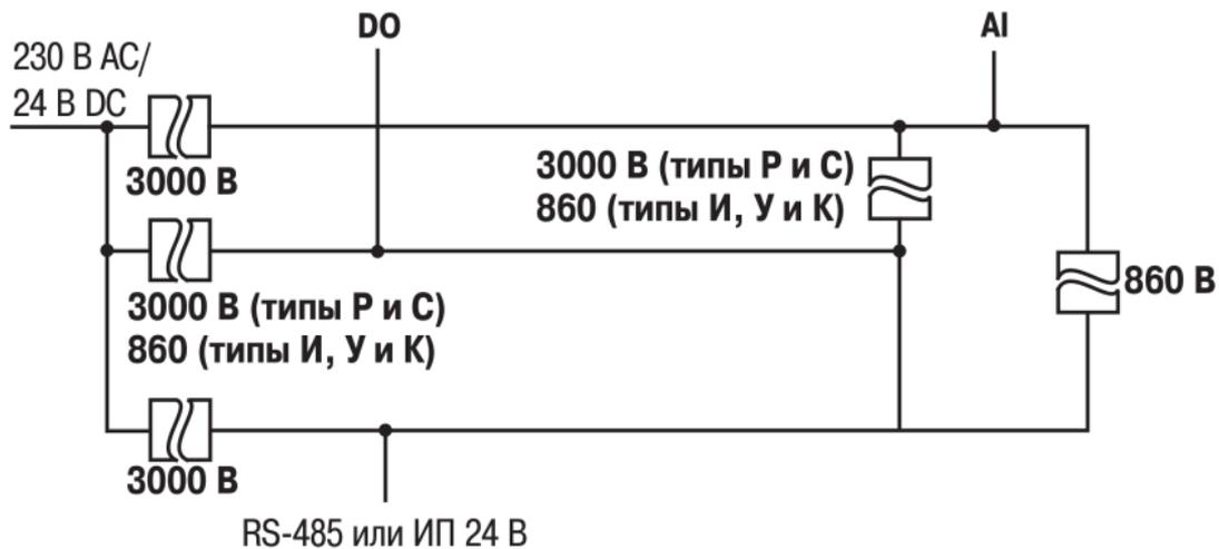
Рисунок 5.3 – Схема гальванической развязки (выходы кроме типа «Т»)
