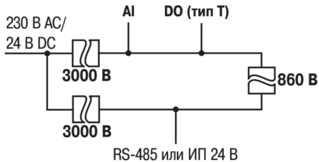
Рисунок 5.2 – Схема гальванической развязки (выход типа «Т»)
