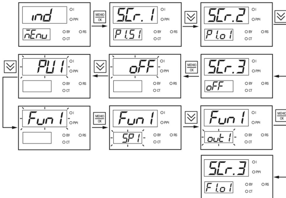
Рисунок 7.6 – Пример настройки экрана
