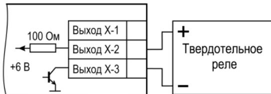
Рисунок 5.18 – Схема подключения нагрузки к ВУ типа «Т»
