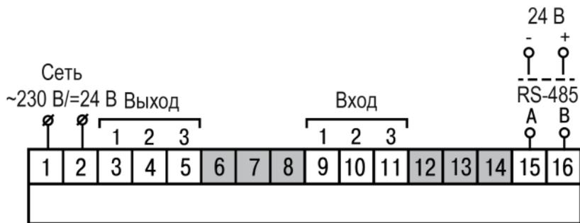
Рисунок 5.7 – Общая схема подключения TRM1–H
