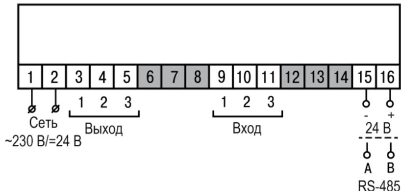
Рисунок 5.4 – Общая схема подключения ТРМ1–Щ1/Щ2
