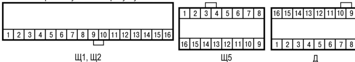
Рисунок Б.1 – Установка переключки
