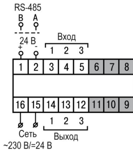
Рисунок 5.5 – Общая схема подключения ТРМ1–Щ5
