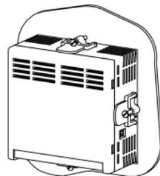
Рисунок 4.1 – Монтаж прибора щитового крепления Щ1
