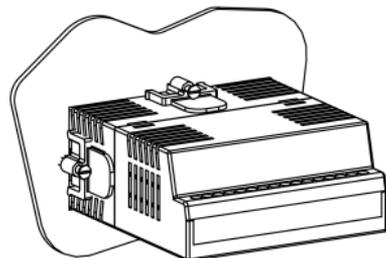
Рисунок 4.4 – Монтаж прибора щитового крепления Щ2
