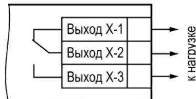
Рисунок 5.16 – Схема подключения нагрузки к ВУ типа «Р»
