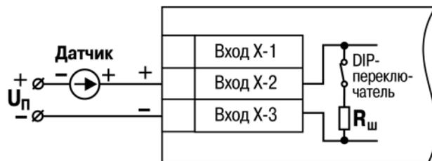
Рисунок 5.13 – Схема подключения пассивного датчика с токовым выходом  $0...5$  мА или  $0(4)...20$  мА
