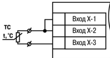
Рисунок 5.10 – Двухпроводная схема подключения ТС
