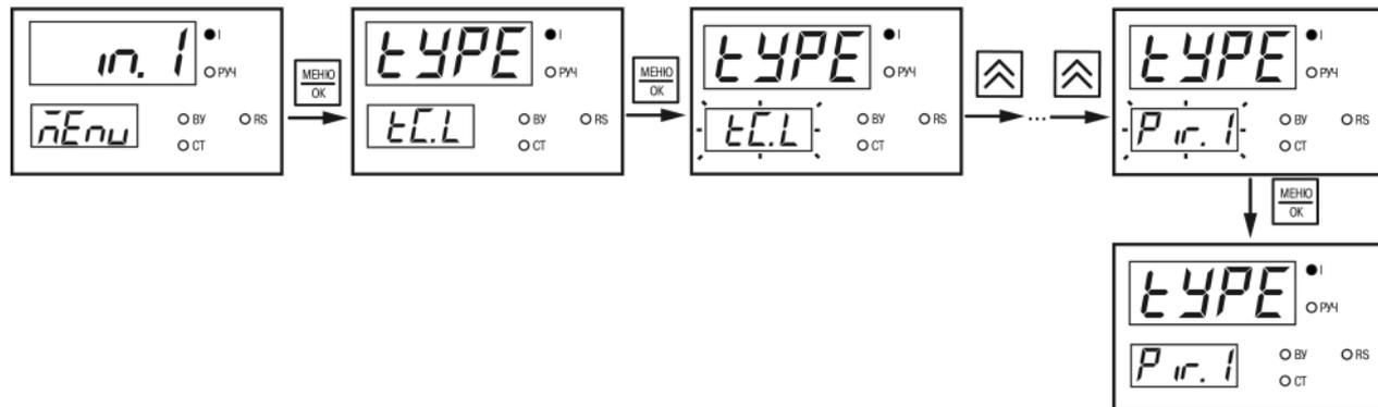
Рисунок 7.2 – Пример настройки параметра
