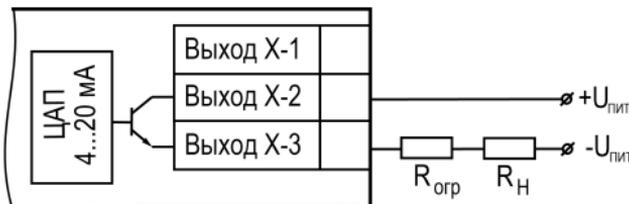
Рисунок 5.22 – Подключение к ВУ типа «И» с ограничивающим резистором
