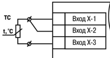
Рисунок 5.9 – Трехпроводная схема подключения ТС
