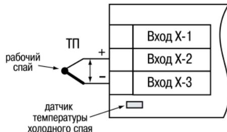
Рисунок 5.11 – Схема подключения термопары
