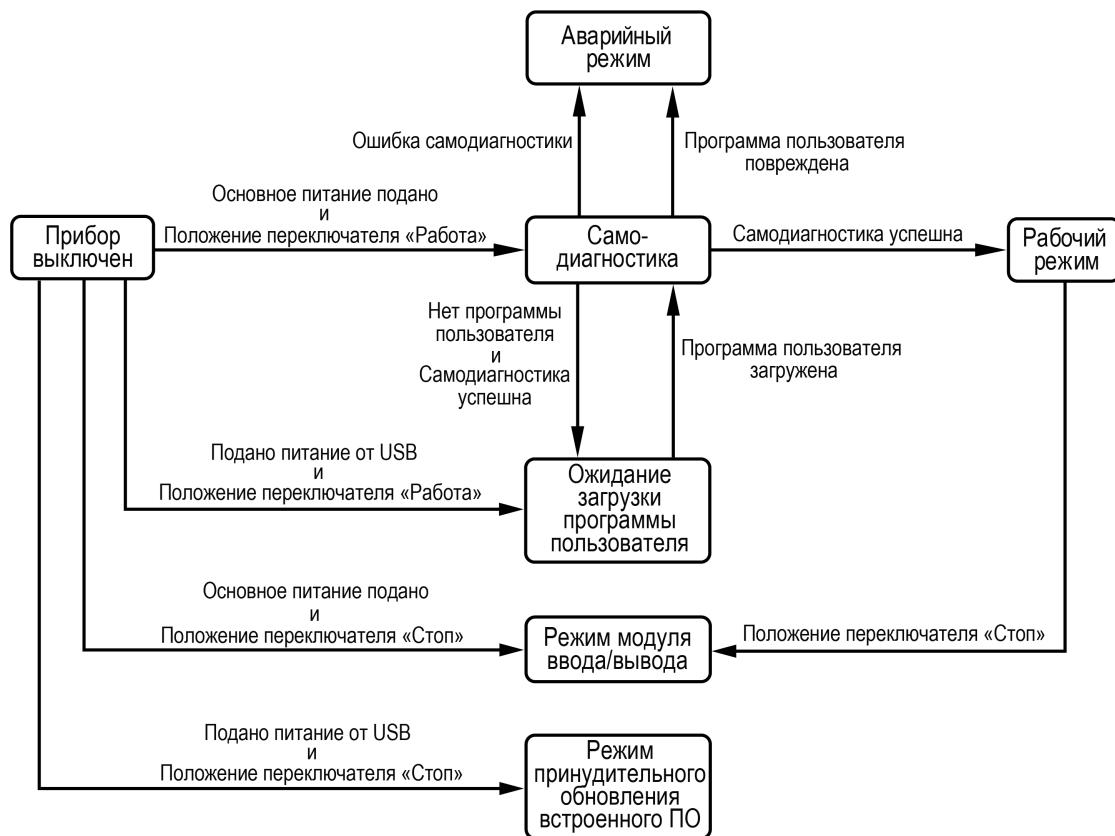
Рисунок 7.3 – Схема переходов между режимами работы
