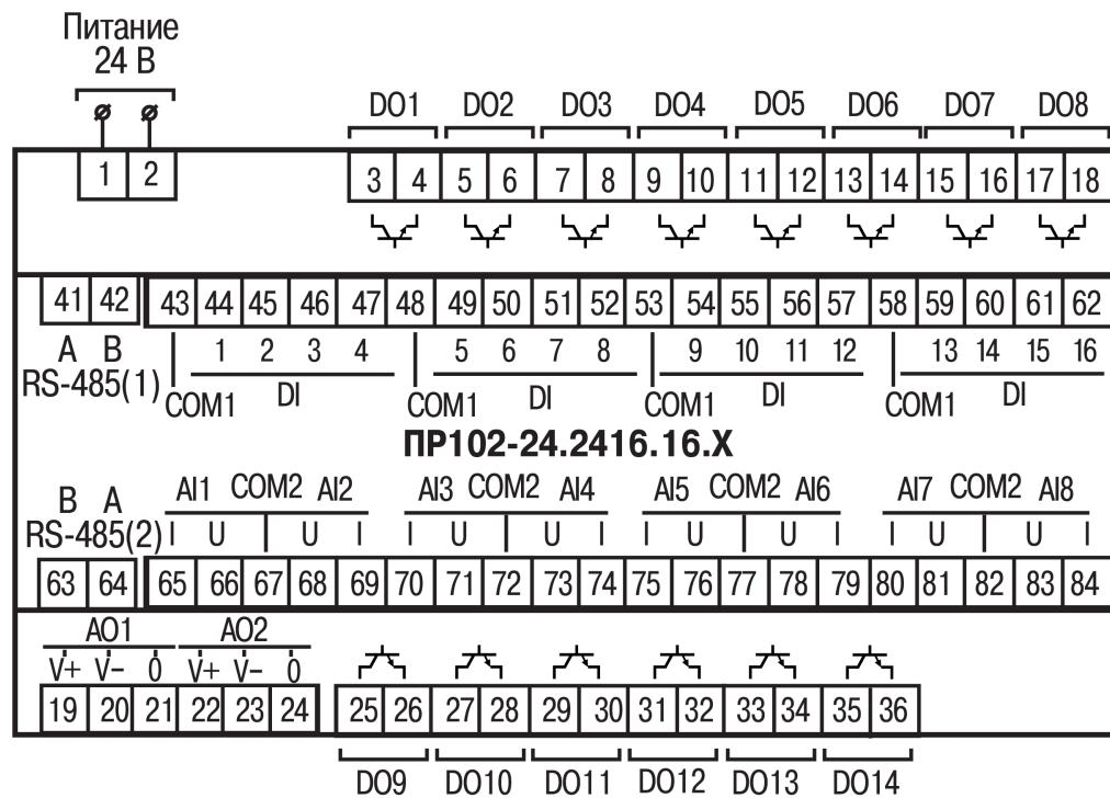
Рисунок А.6 – Расположение контактов для ПР102-24.2416.16.Х
