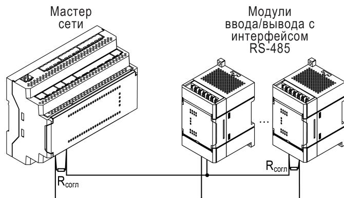
Рисунок 5.17 – Типовая схема подключения в режиме Master
