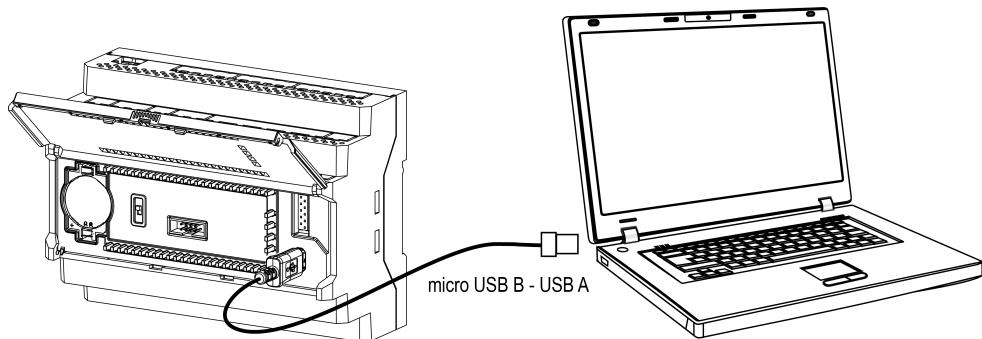
Рисунок 5.18 – Схема подключения прибора к ПК
