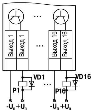
Рисунок 5.10 – Схема подключения нагрузки к ВЭ типа «К»
