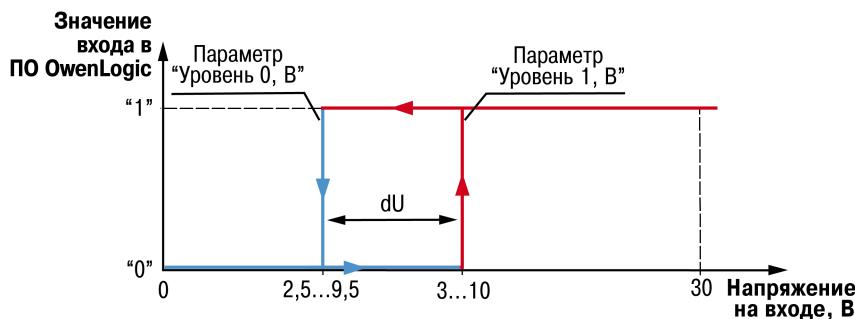
Рисунок 6.4 – Работа универсального входа в дискретном режиме
