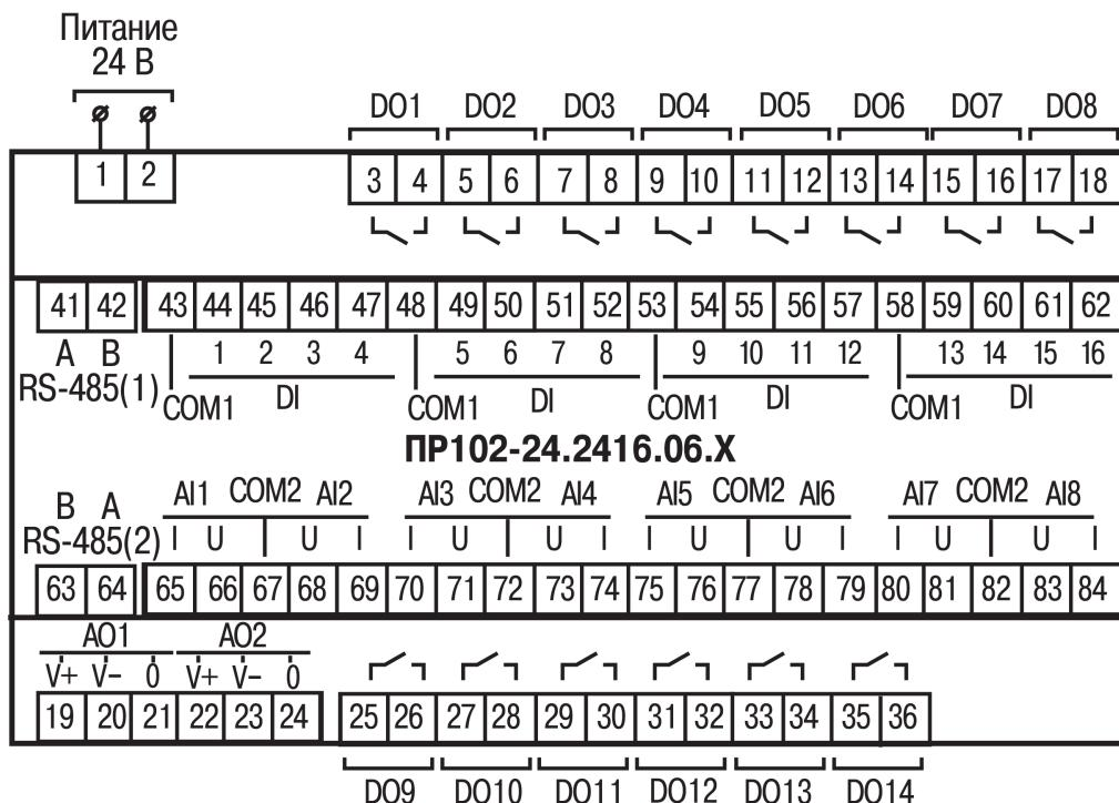
**Рисунок А.5 – Расположение контактов для ПР102-24.2416.06.Х**
