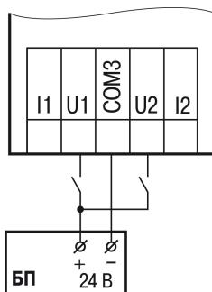
**Рисунок 5.4 – Схема подключения к универсальным входам, работающим в дискретном режиме датчиков типа «сухой» контакт**
