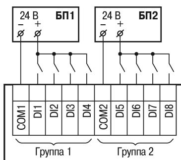
**Рисунок 5.2 – Подключение к дискретным входам датчиков типа «сухой контакт» для сигналов 24 В**
