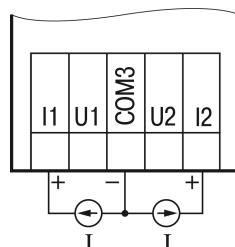
Рисунок 5.7 – Подключение датчиков с выходом в виде тока
