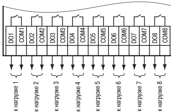
Рисунок 5.11 – Схема подключения нагрузки к ВЭ типа «Р»
