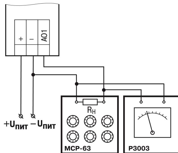
**Рисунок 8.5 – Схема подключения к ВЭ юстировки сигналов типа «4...20 мА» ( $R_H < 300$  Ом)**
