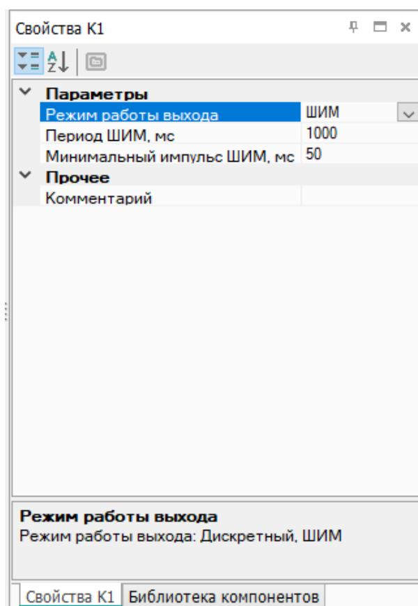
**Рисунок 6.5 – Настройка параметров работы выхода типа «К» в режиме ШИМ**
