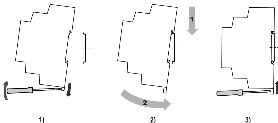
**Рисунок 4.1 – Монтаж прибора**
