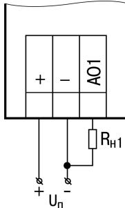
Рисунок 5.12 – Схема подключения к аналоговому выходу токовой нагрузки
