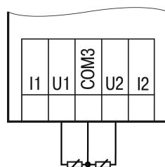
Рисунок 5.6 – Подключение ТС к аналоговому входу
