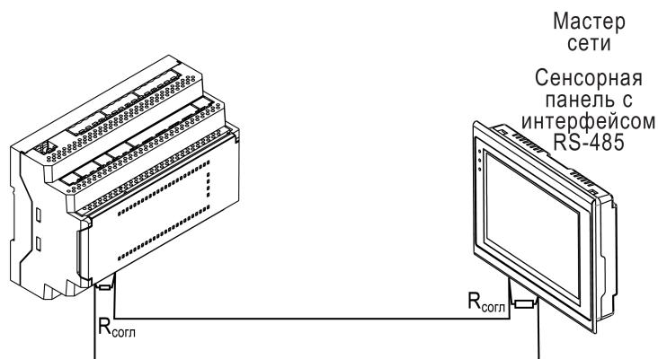
Рисунок 5.16 – Типовая схема подключения в режиме Slave
