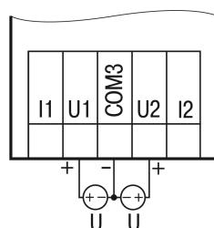
Рисунок 5.8 – Подключение датчиков с выходом в виде напряжения
