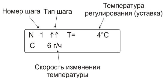
В режиме редактирования программы все параметры текущего шага одновременно отображаются на индикаторе прибора. Переключение между параметрами настройки осуществляется кнопкой ∪, а редактирование
